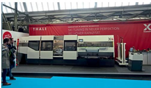
**Thaler** tritt nun als Komplettanbieter auf und stellte den Skischleif-Automaten „X4 Transformer“ in den Mittelpunkt seiner Präsentation. Die Maschine verspricht perfektes Belagsfinish und Design, das jedem das „Weltcupfeeling“ vermittelt. Pro Stunde lassen sich 50 Paar Ski präparieren, was für einen Schönschliff ein Novum ist.
