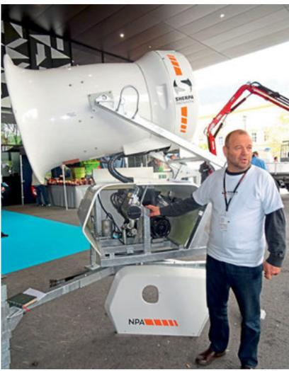
Robert Krajnc erklärte die Vorteile der robusten, unkomplizierten slowenischen Schneemaschine **Sherpa**: Produktion ab  $-1^{\circ}\text{C}$  FKT, Gewicht unter 560 kg, Siemens Industriesteuerung, Energieverbrauch nur 1 kWh pro  $\text{m}^3$  Schnee. Schneitests in Lech ergaben u. a. hervorragende Werte beim Wasserdurchsatz.
