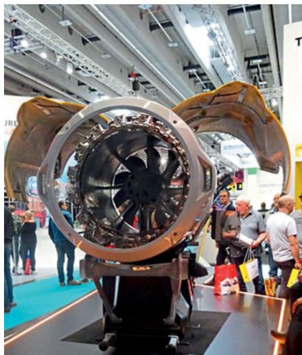
**TechnoAlpin** brachte zwei Neuheiten zur Messe: den Schneeerzeuger **TR10** mit einer völlig neuen Düsenteknik für Vorteile im Grenztemperaturbereich sowie eine neue App, der **Mountain Manager** über den aktuellen Stand der Schneeproduktion sowie Wetterprognosen informiert. Daraus können präzise Prognosen über erzeugbare Schneemengen gemacht werden.
