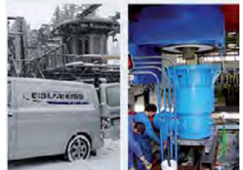
Reparatur eines Lohmann Planetengetriebes vor Ort
