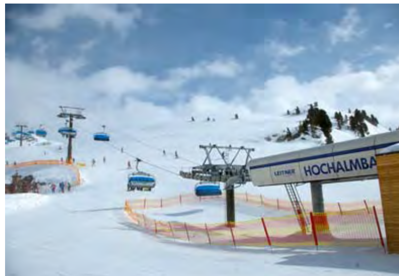
In der Talstation wird die Umlaufgeschwindigkeit der Sessel auf 0,8 m/s reduziert.
