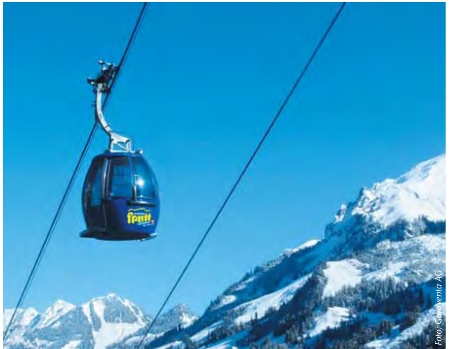
Im Endausbau max. 1700 Person bringt die neue Garaventa-EUB zum Berg. Gleichzeitig lassen sich bis zu 20 Tonnen/h pro Fahrtrichtung mit der 6 m/s-Bahn befördern.
