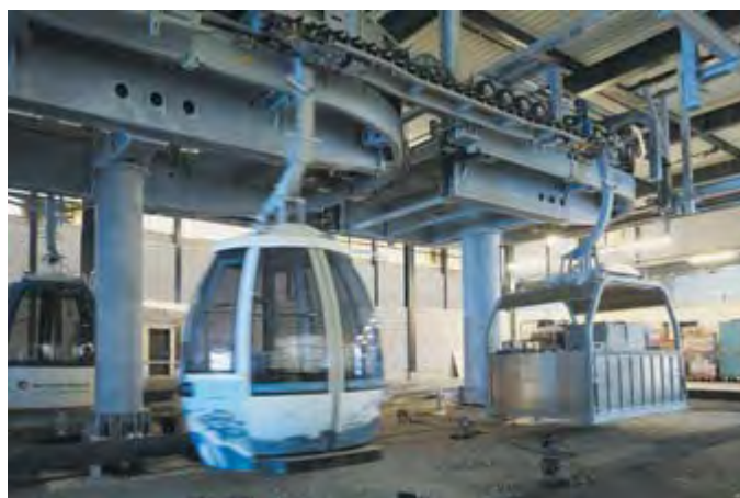
Eine beladene Barelle wartet auf die nächste freie Transportlücke und rangiert automatisch synchron und sicher ein.
