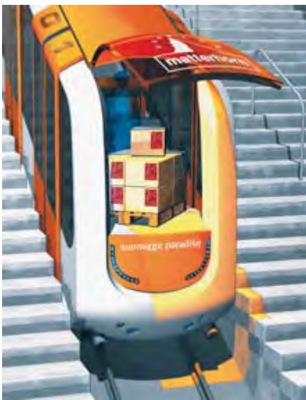
Im Lastentransport laden die neuen Gangloff-Züge des Zermatter Sunnegga-Express über die talseitige Frontklappe. Die funktionell-moderne Gestaltung der neuen Garnituren stammt vom bewährten Gangloff-Partner Kuechler-Design.
