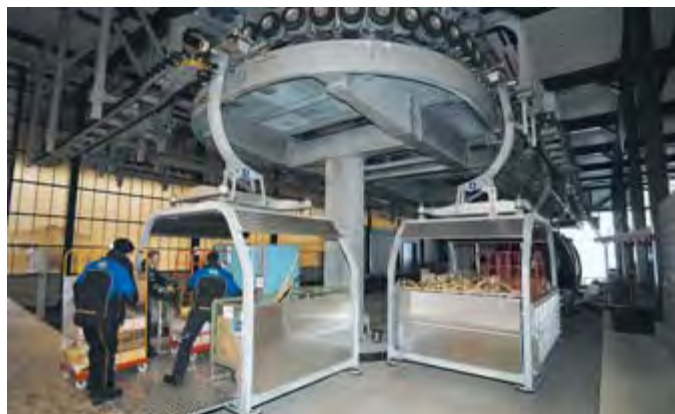
Im Automatikmodus verlassen die Lastbarelle selbsttätig den Umlauf unmittelbar hinter dem Ein- und Ausstieg, wo sie auf über eine Rampe mit max. 1200 kg Waren beladen werden.
