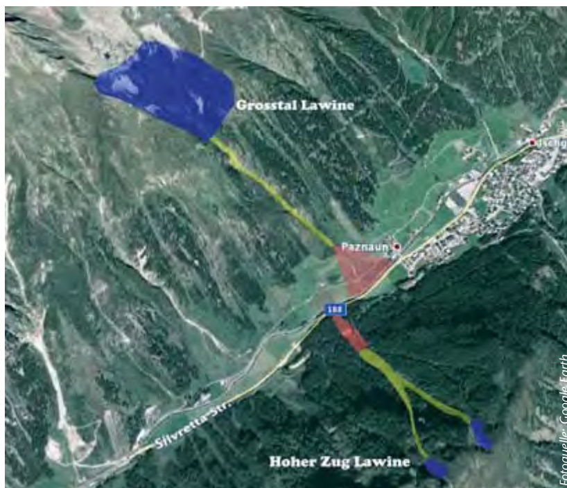
Die „Großtal“- und „Hoher Zug“-Lawinen über der gefährdeten Silvretta-Straße B188.
