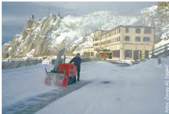
Mit max. 300 t/h Räumleistung bewältigt der ZAUGG Bulldogg nicht nur hohe Schneeschichten, sondern räumt schnell auch große Flächen.
